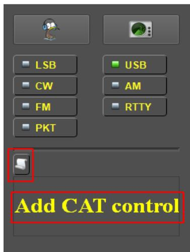
Eine weitere Steuerung des Transceivers ist durch die Angabe einzelner CAT-Befehle möglich.
