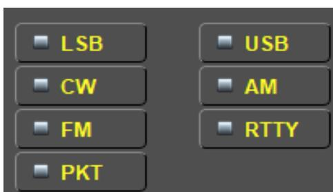
Diese Schalter steuern den Modus, in dem sich Ihr Transceiver befindet.
