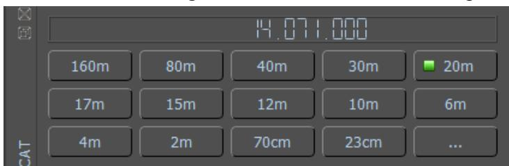
Das ausgewählte Band verfügt über eine kleine grüne Anzeige, die mit der Auswahltaste verknüpft ist.
